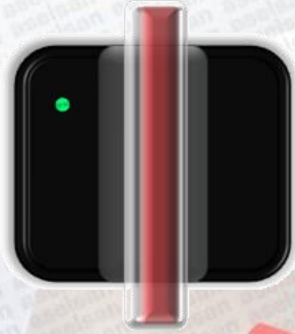
Şekil.2: Kan hortumu içerisinde hava kabarcığı yokken LED yeşil
